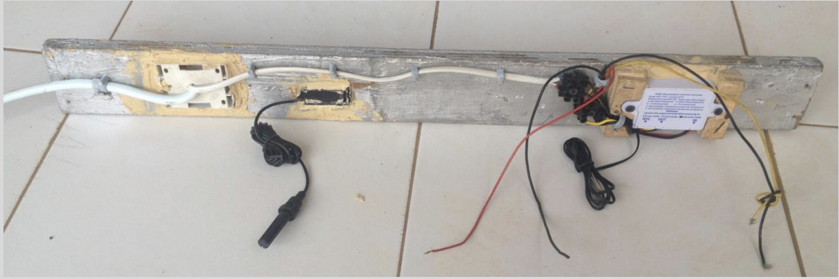
Exemple de montage d'un thermostat, d'un thermo hygromètre et d'un interrupteur (collés avec du mastic)
