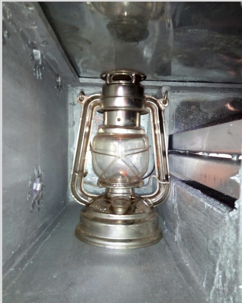
Cage à lampe avec des trous d'aération du côté gauche
