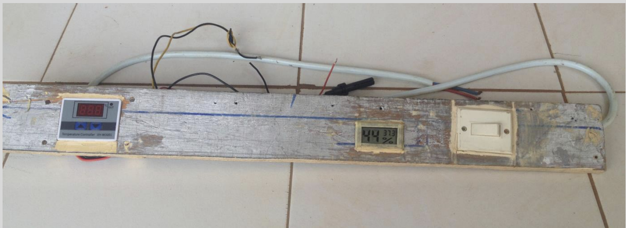
Exemple de montage d'un thermostat, d'un thermo hygromètre et d'un interrupteur (collés avec du mastic)
