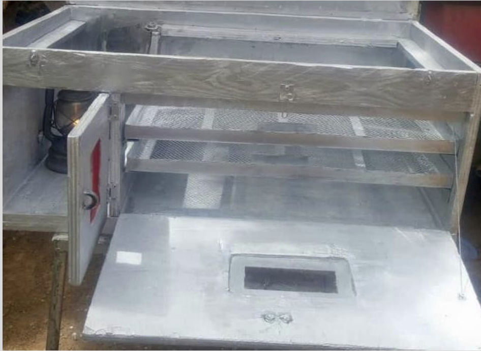
Couveuse à pétrole à 2 plateaux
